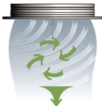
Вертикальная коническая закрученная струя (В)
